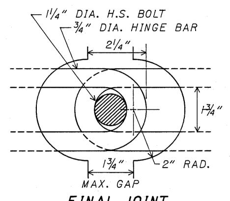
FINAL JOINT BARRIER JOINTS MUST BE FULLY OPEN BEFORE OPENING IS BLOCKED WITH CONCRETE OR HARDWOOD.
