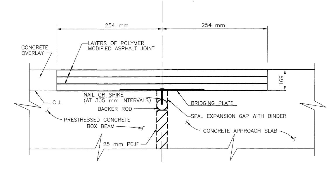
CONCRETE SLAB JOINT
