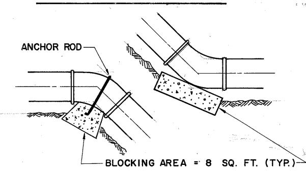
NOTE: ALL BLOCKING SHALL BE POURED AGAINST FIRM UNDISTURBED SOIL.
