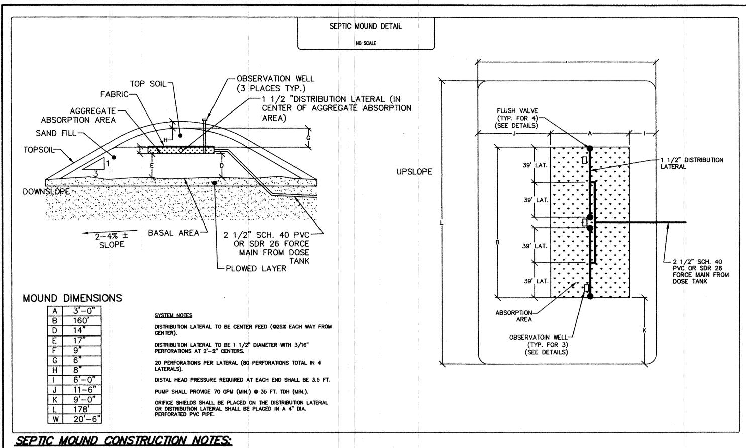
MOUND SHALL BE INSTALLED ALONG CONTOURS.
