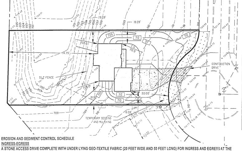
ALL SILT FENCE SHALL BE INSTALLED PRIOR TO ANY EARTHWORK ACTIVITIES AT THE SITE IN THE LOCATIONS SHOWN ON THE SITE PLAN AS WELL AS ALONG THE FRONT OF ANY LOT THAT SLOPES TOWARDS THE STREET.
