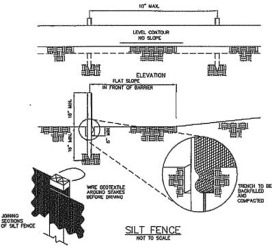
1. SILT FENCE SHALL BE CONSTRUCTED BEFORE UPSLOPE LAND DISTURBANCE BEGINS.
